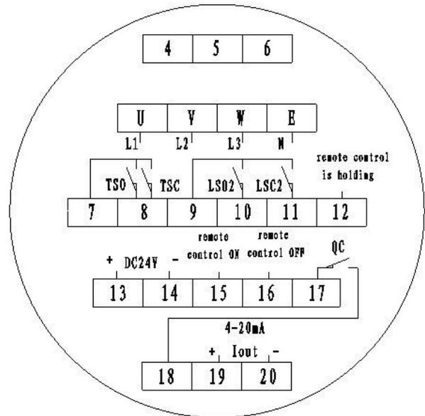
Рисунок 18 Чертеж клемм для встроенного взрывозащищенного переключающего электропривода
