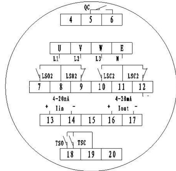
Рисунок 20. Чертеж клемм для электропривода взрывозащищенного коммутационного типа со встроенным регулированием
